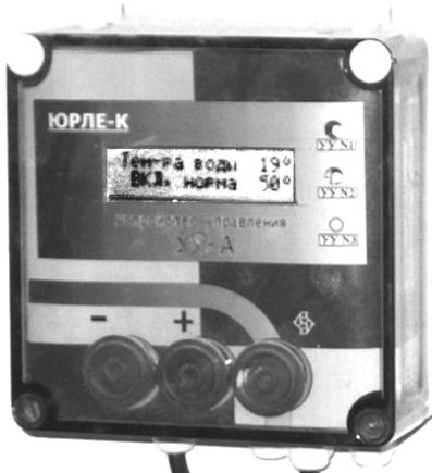
УУ-А является микропроцессорным устройством, регулирующим температуру теплоносителя в контуре путем последовательного включения и выключения необходимого количества тепловых установок.
