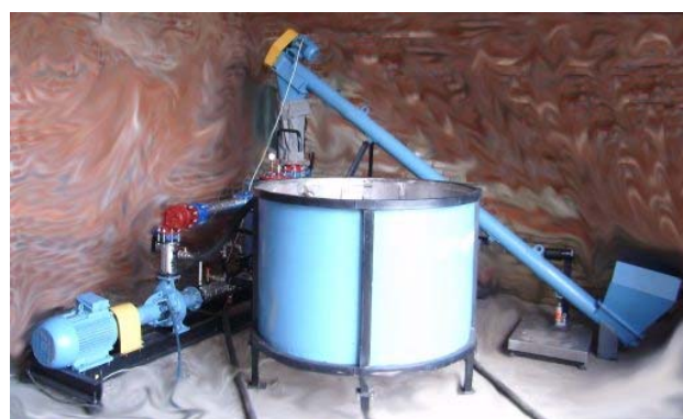
Установка для приготовления заменителей цельного молока и влажных кормов
