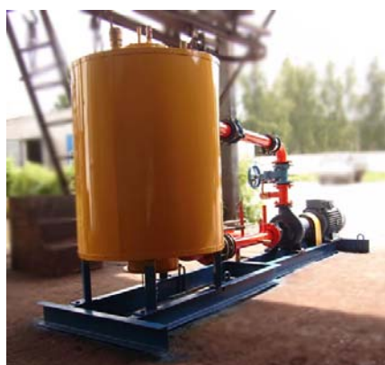
Установка кавитационной обработки смесей для выделения гуминовых веществ из торфа
